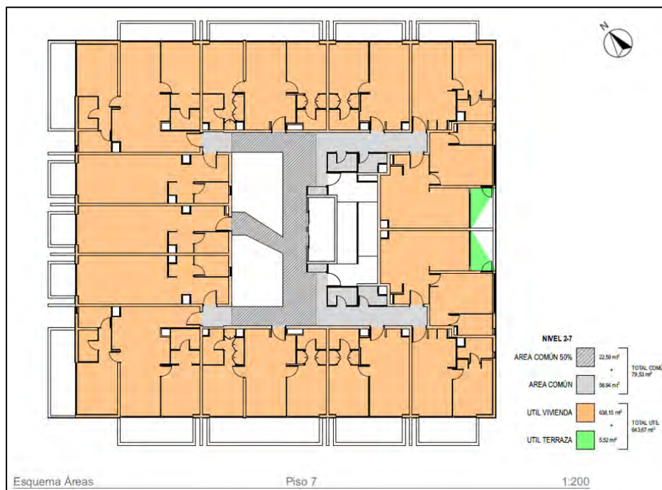
IMAGEN 14: PLANTA 7°PISO, PROYECTO "EDIFICIO LAS VERBENAS".
