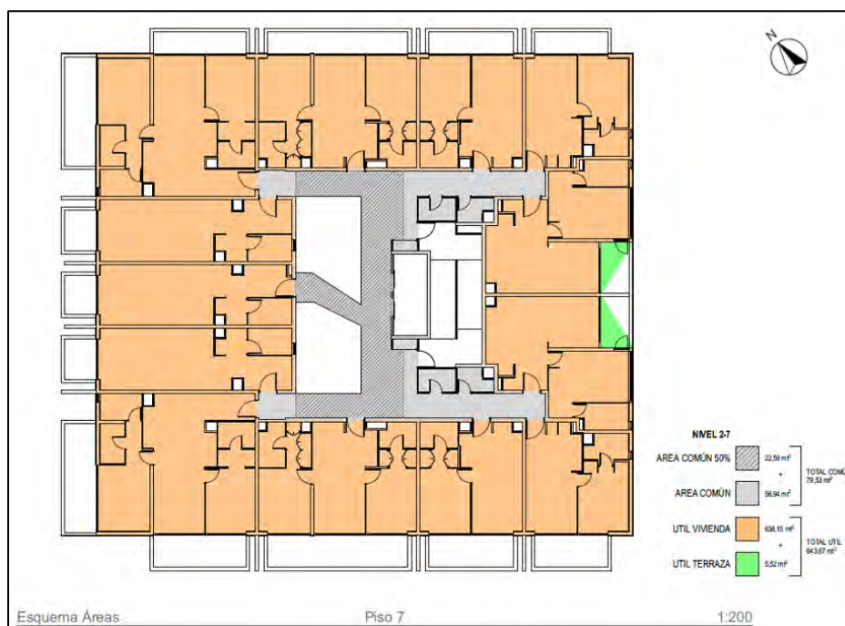
IMAGEN 14: PLANTA 7°PISO, PROYECTO "EDIFICIO LAS VERBENAS".
