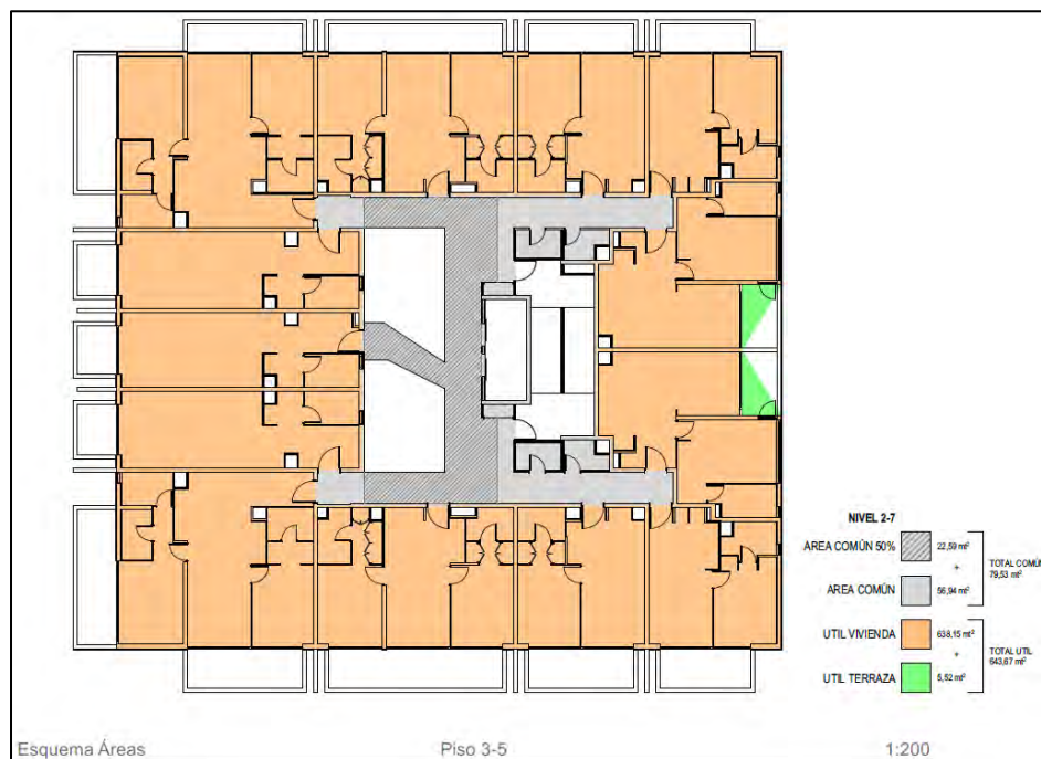
IMAGEN 12: PLANTA PISOS 3° - 5°, PROYECTO "EDIFICIO LAS VERBENAS".
